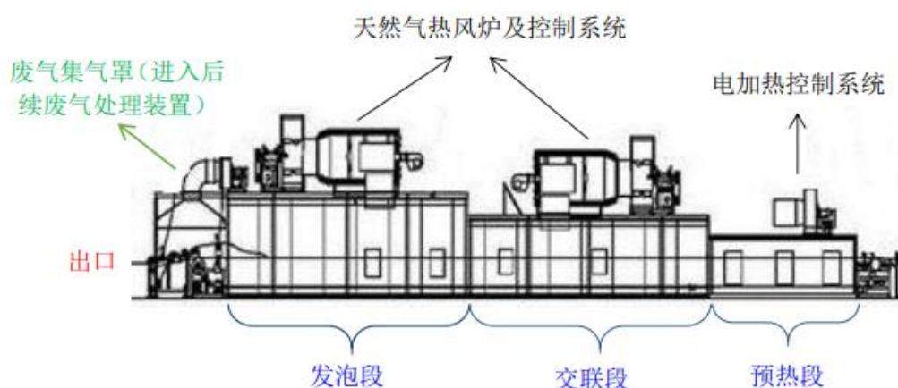
图 2-3 项目发泡炉结构图
