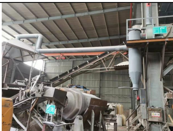
图 7-1 旧砂再生粉尘废气处理装置现场照片
